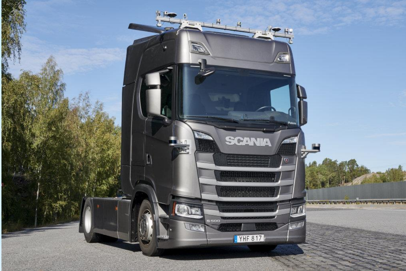
Беспилотный грузовик на базе тягача Scania 4-й уровень беспилотности Эксплуатация по модели Hub2Hub
