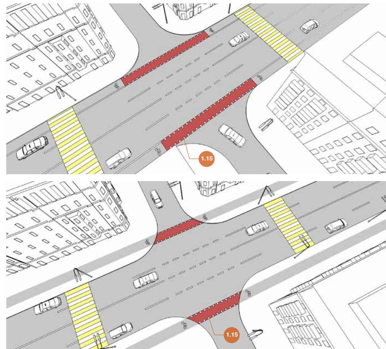
Рисунок 6.27 – Схема примыкания к улице: а) с велосипедной полосой; б) с велосипедной дорожкой
